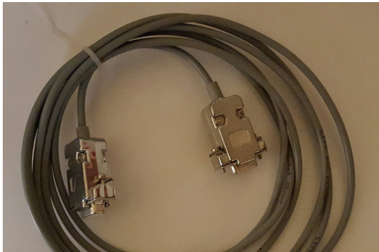
De StarTech USB to Serial kabel altijd aansluiten op de UNIKON pc datakabel en daarna de UNIKON pc datakabel aansluiten op de UNIKON KLOK
